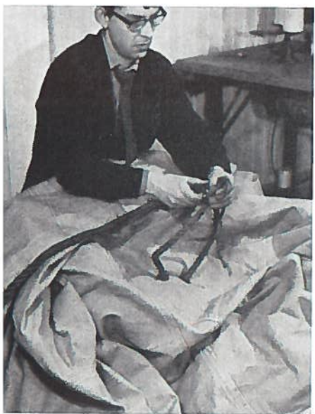
Frank Larsen legger kordelstropp for gording. Nederst til høyre: kaus av pokkenholt bendslet inn i stroppen. (Foto: Arne Emil Christensen, IFF.)
