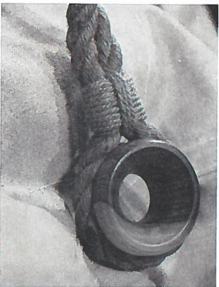
Frank Larsen legger kordelstropp for gording. Nederst til høyre: kaus av pokkenholt bendslet inn i stroppen. (Foto: Arne Emil Christensen, IFF.)
