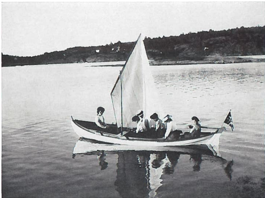
Sørlandsk «råseil». Egentlig et luggerseil som var vanlig på småfartøyer ved århundredskiftet. (Foto: Wilse 10801 NF.)
