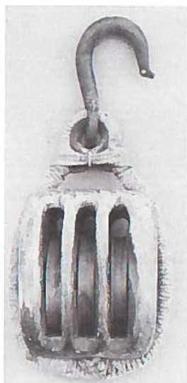
2-skivet blokk. Blokkhus skåret av ett stykke tre, trolig ask. Skiver av pukkenholt. Trenagle. Mål: 44 × 33 × 25 cm. AAM 7190.
