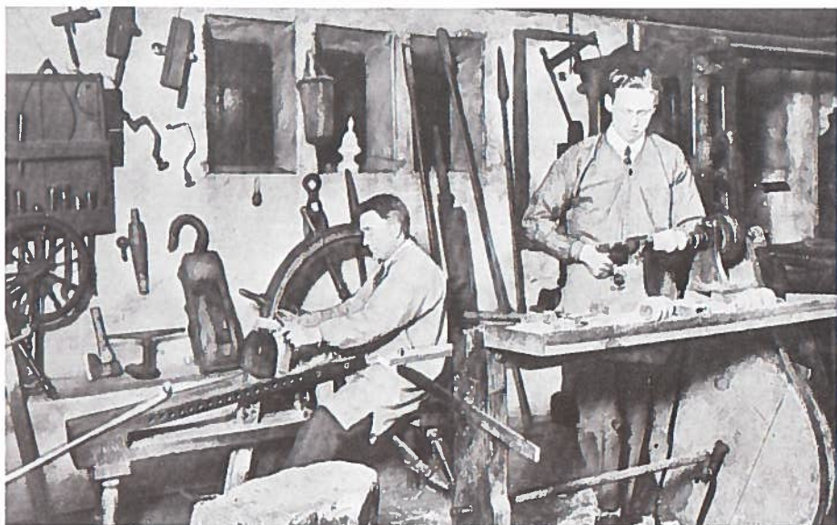
Interiørbilde fra Carl Christian Hasserts blokkmakerverksted slik verkstedet sto montert på Histor. Tekn. Samling. T.h. ser vi en dreierbenk til å trø, bak t.v. benken der blokkene ble satt fast under tilskjæringen. Foto i Dansk Folkemuseums arkiv.
