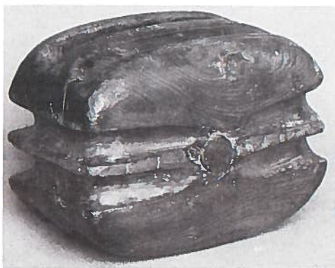
2-skivet blokk. Blokkhus skåret av ett stykke tre, trolig ask. Skiver av pukkenholt. Trenagle. Mål: 44 × 33 × 25 cm. AAM 7190.
