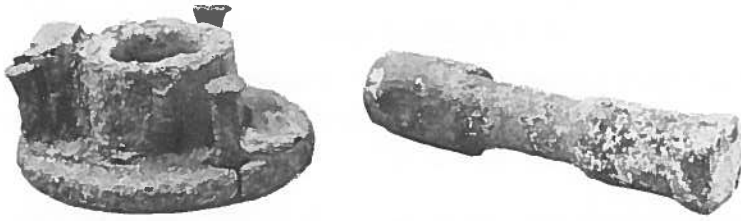
Bøssing med klinkenagler og blokkbolt. Alt av jern. Har tilhørt ei gammel fokkeskjøtblokk på skoneren «Svanen». Blokkboltene er slitt på midten.
