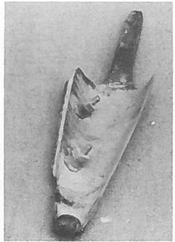
Skrøbor for uthuling av skogangen i skipspumper. Jernet kan utvides ved påsetting av «pålegg». AAM 1862.
