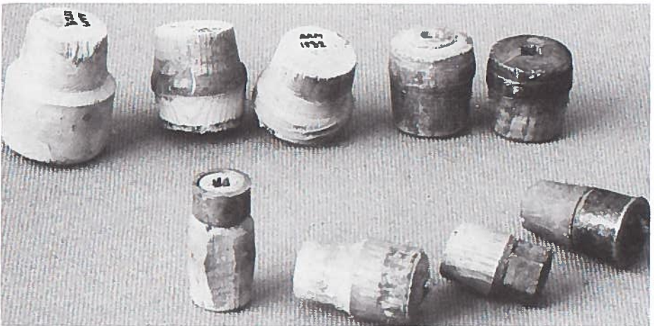
Tilbehør til dreierbenk. Sjokker, feste for bor. Fra Knudsens blokkmakerverksted. AAM 1829—1838.
