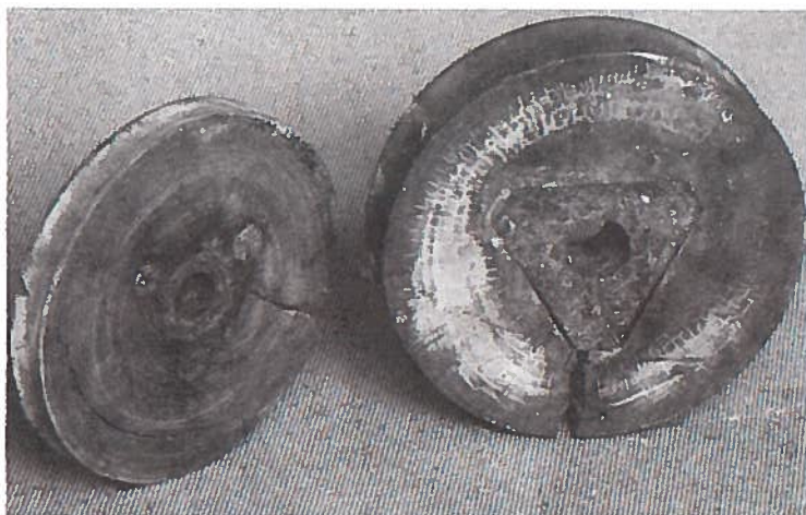
Blokkskiver med jernbøssing. Begge skivene er sprukket. En av innvendingene mot jernbøssinger var at skivene lett sprakk og måtte skiftes. AAM 4875 a og b.
