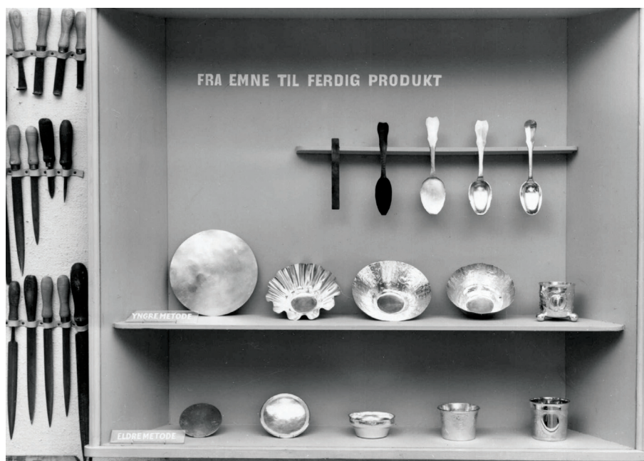
Fra håndverksutstillingen. Den var pedagogisk lagt opp og viste hele arbeidsprosessen fra emne til ferdig gjenstand, her fra gullsmedverkstedet.
