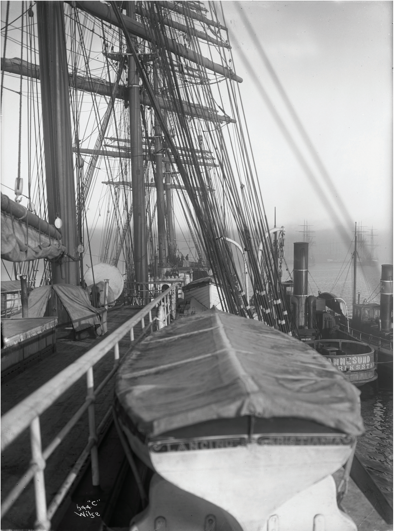
Fullriggeren Lancing (b. 1866, R. Napier & Sons, Glasgow), ble opprinnelig bygget som Atlanterhavsdamperen Pereire og gikk i passasjerfart mellom Le Havre og New York. Den tekniske utviklingen gjorde skipet umoderne, og etter en brann i 1888 ble hun bygget om til rent seilførende lasteskip, uten dampmaskin eller passasjerlugarer. Under navnet Lancing ble skipet kjent som et av verdens hurtigste seilskip. Dette bildet ble tatt av Wilse mens han var ombord i skipet i februar 1908. Foto: Anders Beer Wilse/Norsk Maritimt Museum
